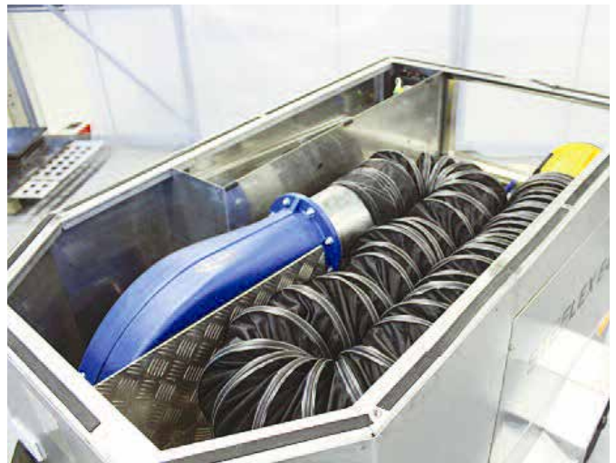
Воздушный шланг хранится внутри шасси обогревателя
